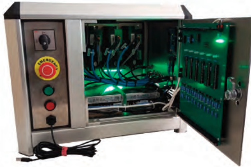
Imatge 1. Controlador amb la porta oberta.
